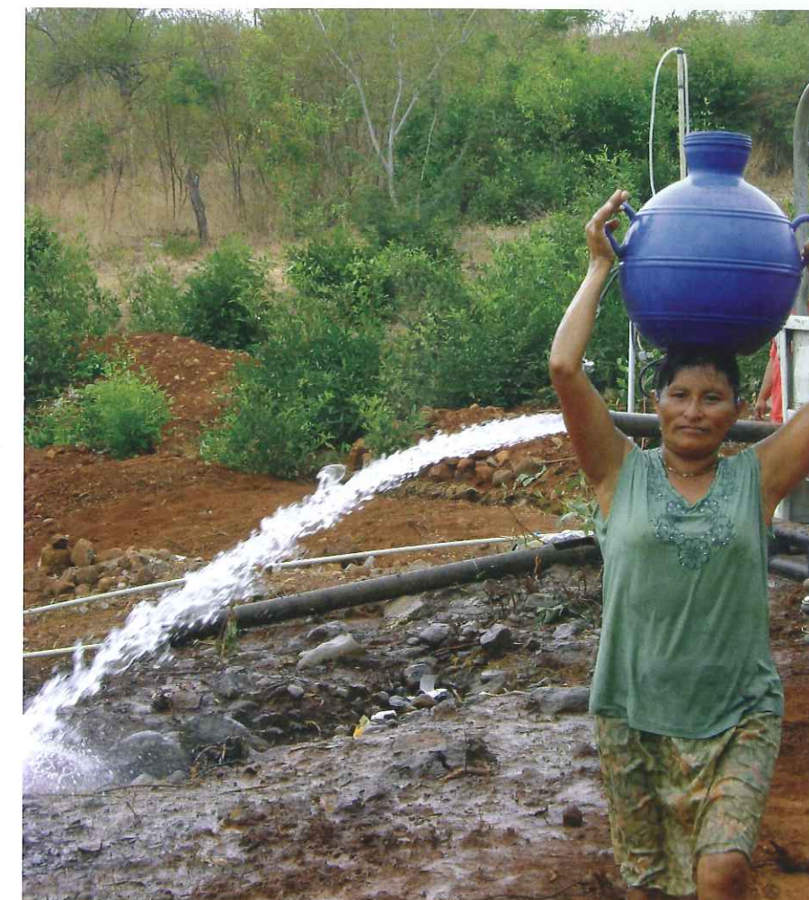
Figura 1. Ensayo de bombeo.
