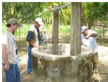
Medición de la profundidad del nivel estático del agua subterránea con la sonda piezométrica. Municipio de Intipucá, La Unión
